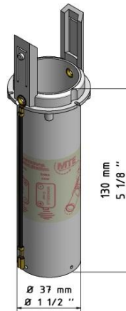
3 Volt Köcher für 2 Monozellen = doppelte UpM
